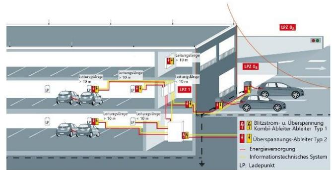
Zusätzlich zu dem Schutz der Energieversorgung ist die Datenübertragung für die Erfassung der Verbrauchsdaten zu schützen. Der informationstechnische Anschluss ist, in Analogie zum Energieanschluss, mit SPD Type 1 (D1 und C2) oder SPD Type 2 (D1 und C2) vorzunehmen.
